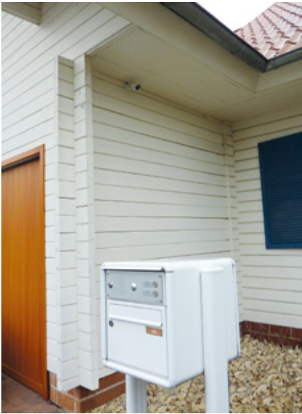
Im Briefkasten ist neben einer Kamera und Sprechanlage ein Sensor integriert, der meldet, wenn Post eingeworfen wird.
