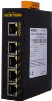
La serie KIEN1005S consiste in switch PoE non gestiti a 5 porte prodotti da Kyland che forniscono 1 porta RJ-45 Fast Ethernet e 4 porte PoE 10/100 Base-TX conformi a IEEE802.3af. Mentre trasmette i dati sul cavo, ogni porta PoE può emettere 15,4 watt direttamente ai terminali PoE, eliminando la necessità di un ulteriore cablaggio. Ha un involucro metallico IP40 e un consumo energetico ridondante, che lo rende una soluzione economica per applicazioni ITS, di videosorveglianza e di automazione.
