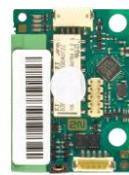
**Modulo I/O 2** ingressi/uscite, contatto a relè 30 V/1 A AC/DC (NO/NC), ingresso per interruttore antiapertura, può essere installato nel modulo base e in ogni modulo di espansione
