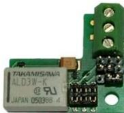
**Contatto di commutazione aggiuntivo Helios IP** set di installazione su Helios Vario analogico modulo base, 2. Relè (contatto a potenziale zero)
