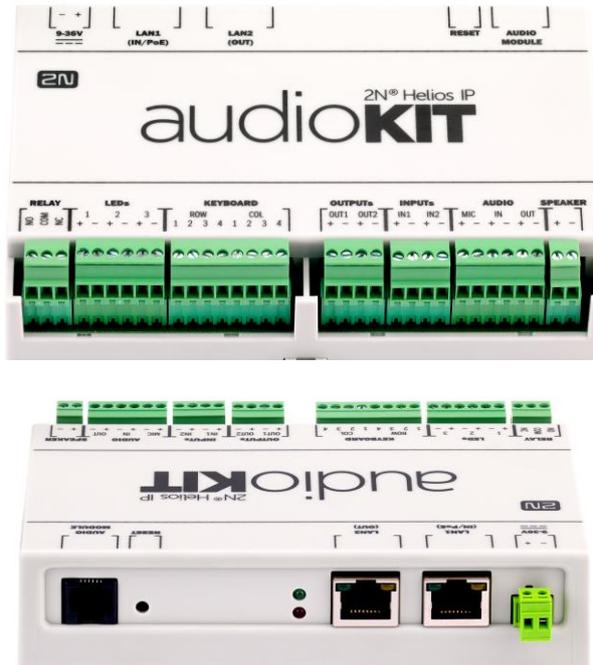
Le kit audio IP 2N® est un module électronique qui se monte par l'arrière pour moderniser les interphones de porte existants et en faire des stations SIP.
