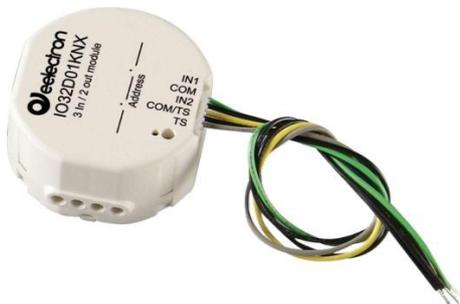
Il modulo KNX comprende 2 ingressi digitali, 1 ingresso analogico e 2 uscite a relè bistabili. Le uscite digitali sono progettate per il collegamento a contatti senza potenziale e possono collegare sensori, pulsanti convenzionali, ecc. tramite un'interfaccia. Possono essere utilizzati per comandi on/off, oscuramento, controllo delle tende, recupero e controllo delle scene, sequenza di 3 oggetti.
