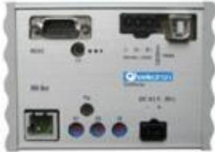
Il KNX-DMX Gateway è un'interfaccia tra il bus KNX e il bus DMX512. Combina elementi di automazione degli edifici con dispositivi di illuminazione ed effetti speciali per tutte le esigenze. Il gateway KNX-DMX è unidirezionale, riceve telegrammi di dati sul bus KNX e li trasmette sul bus DMX512. L'interfaccia permette gli attuatori DMX512 di comunicare attraverso il bus KNX con l'intera gamma del canale.
