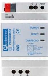
Stromversorgung zur Erzeugung der Busspannung an einer Leitung mit einem max. Strom von 640 mA. Mit integrierter Drossel zum Entkoppeln der Spannungsversorgung vom Bus. Anschluss über Schraubklemmen, Montage auf Hutschienen EN 50022, Verbindung über Busklemmenanschluss.
