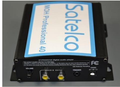
**Il sistema MOH Professional 40 riproduce il messaggio interno di default quando si scollega la chiavetta USB dal lettore. Se la chiavetta USB è inserita, uno dei messaggi memorizzati sulla chiavetta USB partirà automaticamente entro 10 secondi.**
